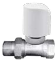
Клапан двухходовой с сервоприводом SRV2 позволяет управлять подачей теплоносителя в автоматическом режиме от сигналов управления контроллера или терmostата. Используя клапан с сервоприводом в комплекте с автоматикой вы получите более точный контроль за расходом теплоносителя, что приводит к экономии энергоресурсов.
