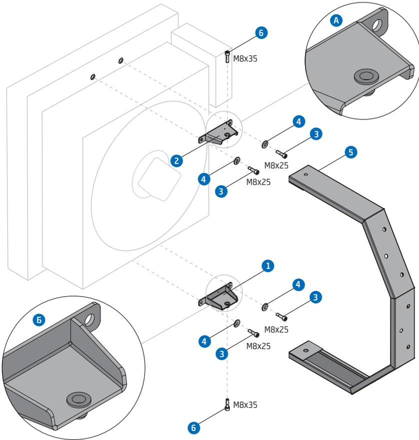
1. Закріпити на корпусі тепловентилятора кронштейни **1**, **2**, використовуючи болти **3** і шайби **4**. Простежити за положенням кронштейнів – вигляд **A**, **B**.
