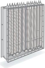
Нагрівальні елементи, встановлені в тепловентиляторах PROTON EL виконані з високолегованої неіржавіючої сталі. У моделі **EL 12|EL 12 IP** використовуються **гладкі ТЕНИ**, а в моделях **EL 23|EL 23 IP та EL 30|EL 30 IP**, оскільки вони є більш потужні, використовуються **орєбрєні ТЕНИ** зі збільшеною тепловіддачею. Рама кріплення ТЕНів виконана з оцинкованої сталі. Термодатчики захисту ТЕНів від перегріву змонтовані у верхній і нижній частині рами.
